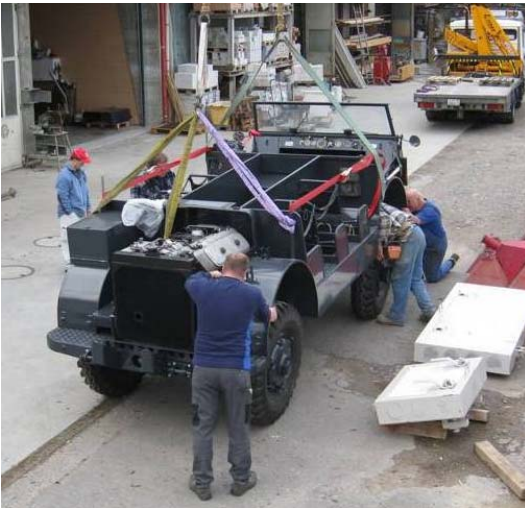
Aufsetzen Karosserie auf M+40014.
