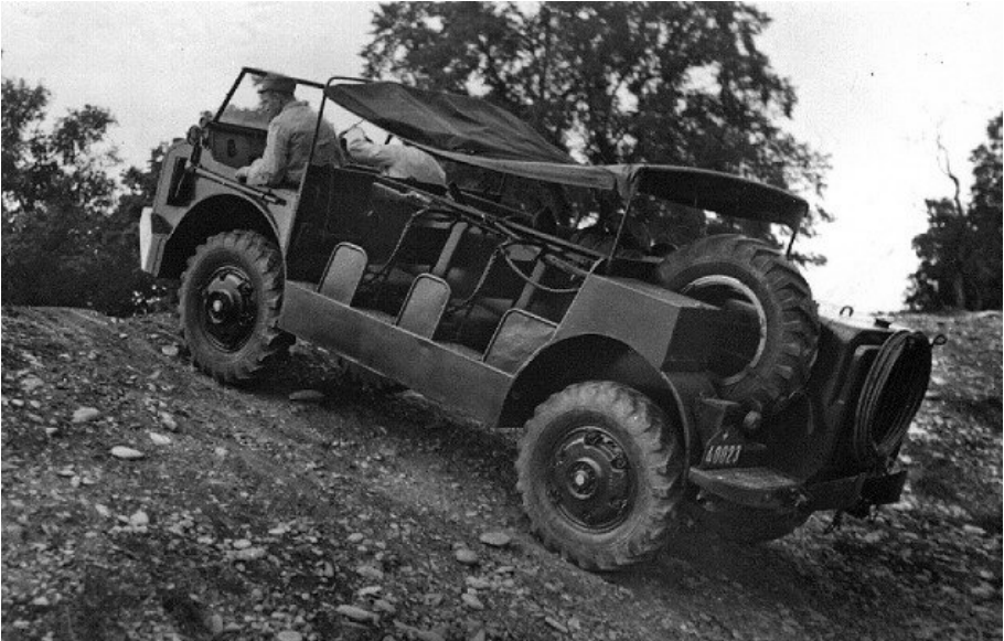
Saurer 4MH im Gelände. Gut zu sehen ist die Drahtseilrolle am Heck des Fahrzeugs. (Aufnahme K.T.A./Sammlung Marcel Zaugg, Mirchel)
